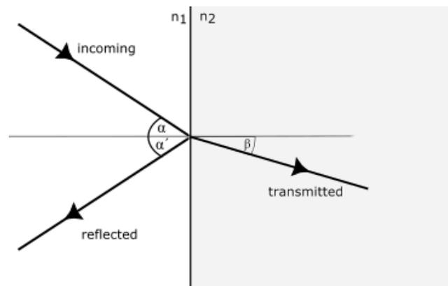
**Abbildung 1:** Reflexion und Transmission eines Lichtstrahls zwischen zwei Medien verschiedener Brechungsindizes.
